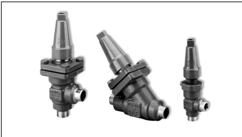
Вентили типа REG представляют собой угловые и проходные регулирующие вентили, которые в закрытом положении работают как обычные запорные вентили. Вентили изготовлены согласно жестким требованиям к качеству, предъявляемым к холодильным установкам международными сертификационными органами; тщательный расчет обеспечивает благоприятные параметры потока и точные линейные характеристики.
