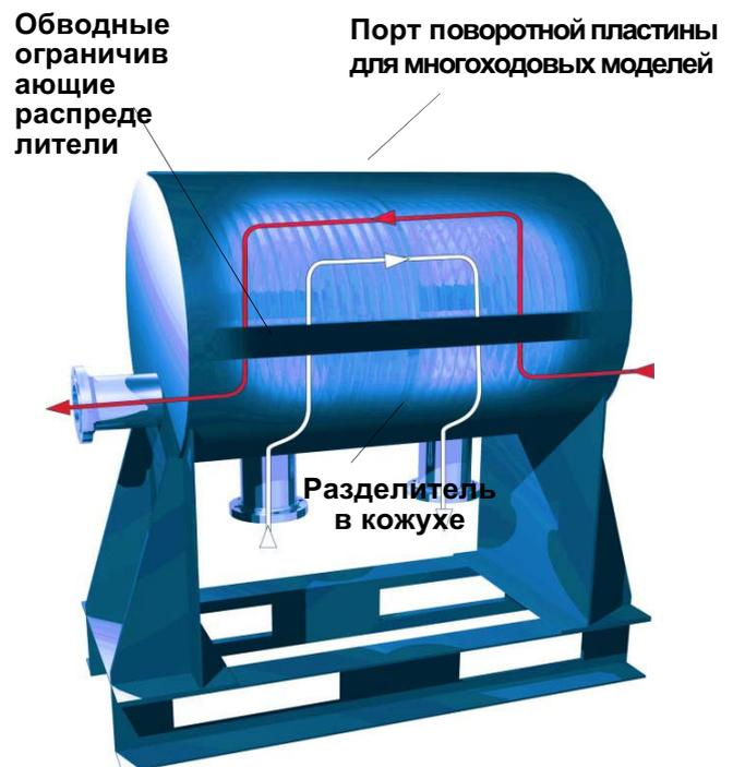
Пластинчатый теплообменник обычно служит для нагрева или охлаждения среды малой или средней вязкости. Специальный теплообменник спроектирован с учетом удельной производительности, указанной в документации на него, не допускается использование любыми другими способом без консультации с поставщиком.
