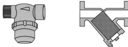
Если в какой-либо среде присутствуют частицы более 1 мм, рекомендуем установить перед обменником сетчатый фильтр с размером отверстий 1,5 мм. В противном случае эти частицы могут заблокировать каналы, что приведет к плохой работе, увеличит перепад давлений и риск замораживания.
