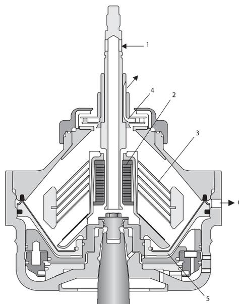
Типовая схема центробежного сепаратора с выгрузкой отделяемой твердой фазы в варианте исполнения в качестве кларификатора. Показанные на схеме детали не обязательно соответствуют реальному устройству описываемого сепаратора.
