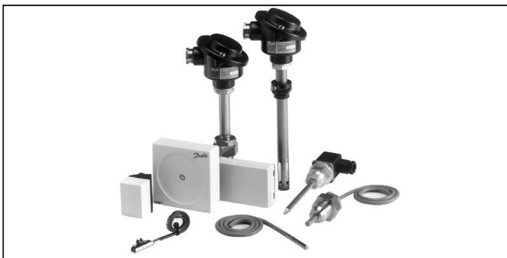
Датчики температуры AKS и ESM представляют собой резисторные датчики, сопротивление которых зависит от температуры. В состав датчика входит платиновый элемент, величина сопротивления которого изменяется пропорционально изменению температуры. За исключением одного типа датчика с платиновым элементом Pt 500 Ом все остальные датчики представляют собой устройства с платиновым элементом Pt 1000 Ом.
